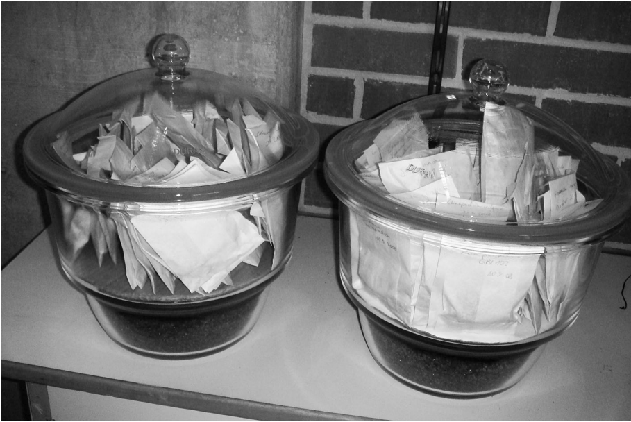
Abb. 1: Im Anschluss an die Nachreife und Säuberung werden die Diasporen zunächst in Exsikkatoren getrocknet. After the air drying and cleaning process seeds are placed in dehydrators.
