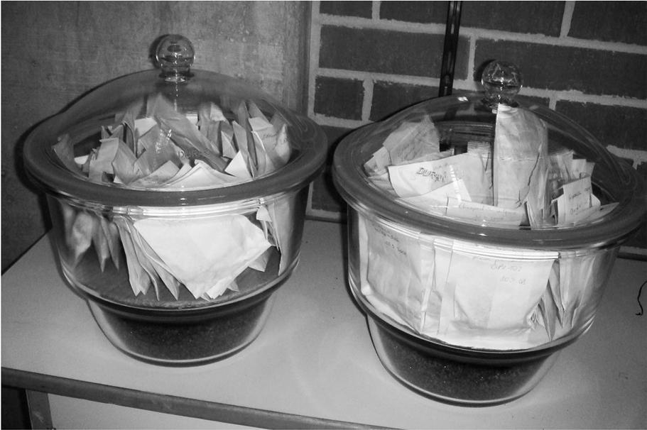
Abb. 1: Im Anschluss an die Nachreife und Säuberung werden die Diasporen zunächst in Exsikkatoren getrocknet.
