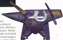
Amboss mit Zange, Hammer und noch ungeformtem Hufeisen.
