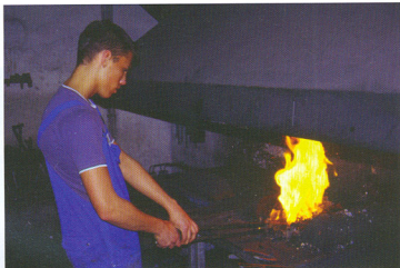
Das Flacheisen wird in der Esse erhitzt.
