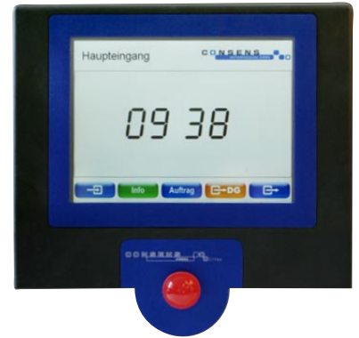
Eine zuverlässige Berührungslos-Leseinheit für alle gängigen 125KHz Codeträger. 1
