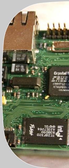
Das CT774\_BASE OEM Modul ist ein ARM basierender SBC mit allen notwendigen Anschlüssen für Netzwerk, RS-232, LCD, Keypad SPI und IO Leitungen.
