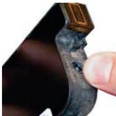
Auf der Unterseite der Patrone neben dem Druckkopf erkennt man das Füllloch, welches mit einem kleinen, runden, schwarzen Aufkleber verschlossen ist. Diesen einfach mit einem Messer runter kratzen. Darunter wird nun eine kleine Stahlkugel sichtbar, diese einfach mit einem Kugelschreiber ohne Mine, einem Stichel, Nagel, einer starken Nadel etc. vorsichtig in das Innere der Patrone stoßen. Diese Kugel verbleibt dann problemlos in der Patrone und „schwimmt“ in der neuen Tinte.
