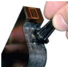
Durch das Füllloch werden nun langsam mit der Spritze etwa 35 - 42 ml Tinte eingefüllt. Die Nadel ganz gerade und vorsichtig einführen, den weichen silbernen Sack im Inneren der Patrone nicht durchstechen !!! Einfach und sicherer geht es wenn Sie den Nadelschutz auf der Spritzennadel drauf lassen und von dem vorne nur ca. 3 mm abschneiden. Dann haben Sie gleichzeitig einen Anschlag und können mit der Nadel nicht zu tief rein stechen.
