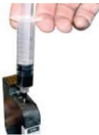
Wenn die Patrone nun wieder mit der Kugel verschlossen ist, drehen Sie sie um, so dass die Düsen nach unten zeigen. Drücken Sie noch einige Male leicht auf die Seitenwände, damit Schaum, Luftblasen und Tinte aus dem Druckkopf austreten.
