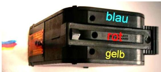
**Wichtig:** Die Befüllungsöffnungen dürfen nicht dicht verschlossen werden! Kleben Sie ein Stück Klebestreifen darüber, müssen Sie mit der Nadel unbedingt wieder kleine Löcher zur Belüftung rein stechen.
