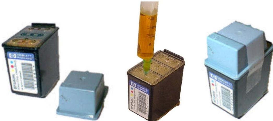
Schneiden Sie vorsichtig mit einem scharfen Messer (Cutter) oder einer kleinen Säge den Deckel von der Patrone runter. Empfehlenswert ist unser „Patronenöffner“ für diese Patronenserien! Der Deckel ist an den Kanten des schwarzen Patronengehäuses aufgeklebt.
