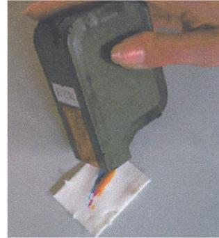
Sollte der Ausdruck dann noch nicht in Ordnung sein, stellen Sie die Patrone für ca. 20 Sekunden in eine Schale mit lauwarmen Wasser, so dass die Düsen ca. 2 – 5 mm tief eintauchen. Wischen Sie den Druckkopf ab und versuchen Sie es erneut.
