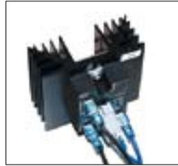
Halbleiterrelais zur Ansteuerung der Ofenheizung. Geräuscharm im Betrieb und nahezu verschleißfrei schalten die Halbleiterrelais in kurzen Takten zur optimalen Angleichung des Temperaturverlaufes an die Brennkurve.
